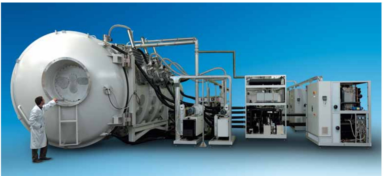
23. Simulatore spaziale per prove combinate temperature-vuoto e misurazione ottica su componenti di satelliti
